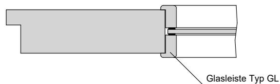
Maße gelten für gefälzte Elemente, bei stumpfen Elementen müssen seitlich und oben 13mm abgezogen werden
