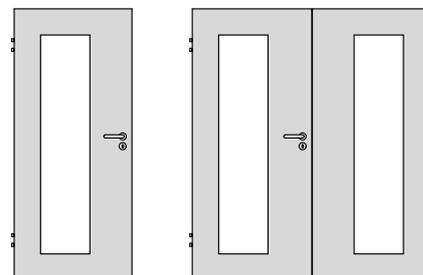
\*Bei den Glasmaßen sind umlaufend 2,5mm Luft zum Türblattausschnitt berücksichtigt!
