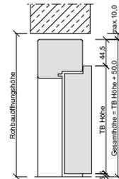
Rohbauöffnungshöhe bei GH max. 2760 mm !
