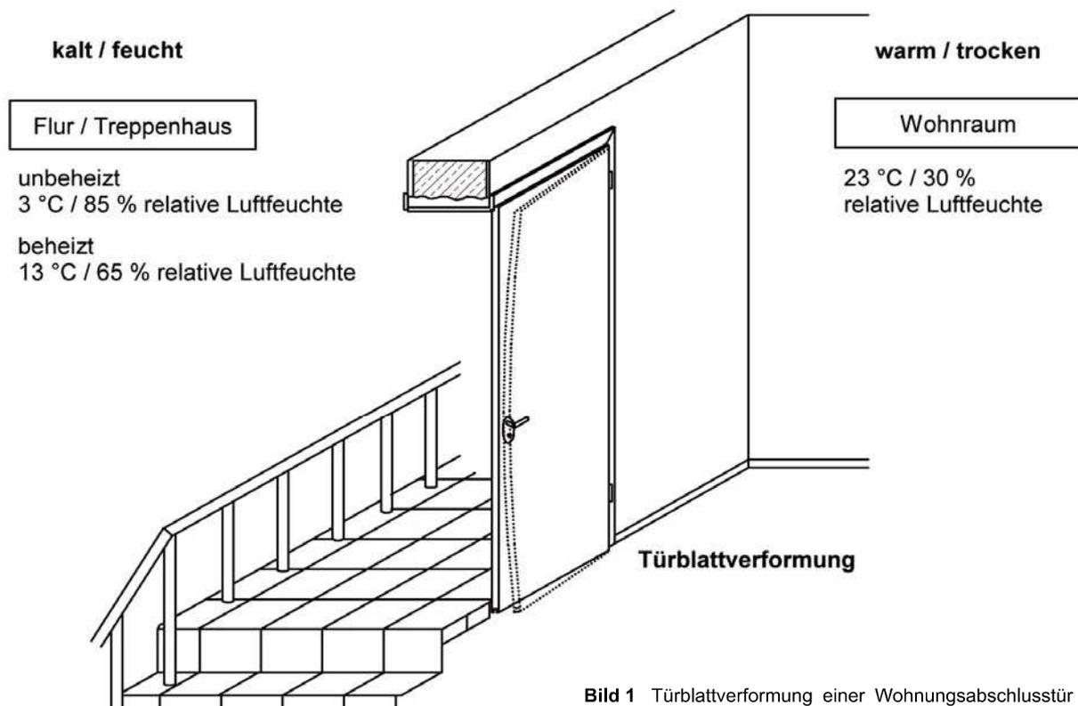
**Bild 1** Türblattverformung einer Wohnungsabschlusstür bei Differenzklimabeanspruchung
